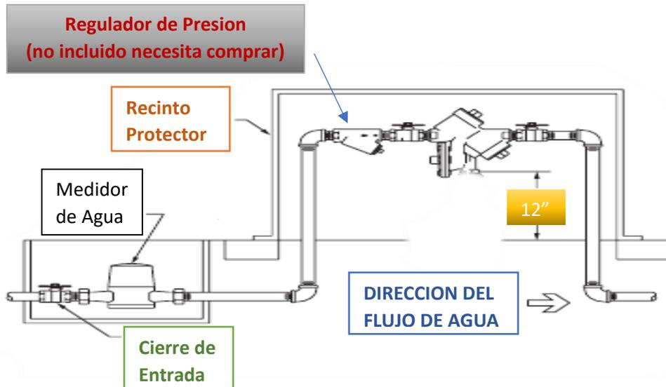
1. El dispositivo de Reflujo de Agua se instalara en el lado del Medidor de la propiedad, donde sea visible
